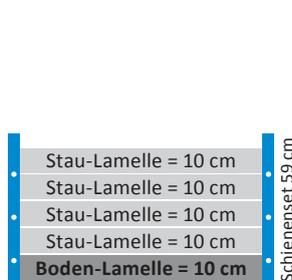
Maximale Stauhöhe bei vollständiger Bestückung: 50 cm
