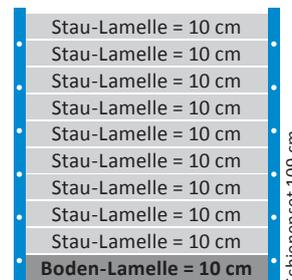
Maximale Stauhöhe bei vollständiger Bestückung: 100 cm
